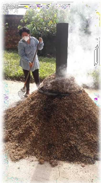
Procesamiento de carbonización de la cascarilla de arroz, el proceso toma un promedio de 4 a 5 horas, el cual se tiene que ir removiendo constantemente
