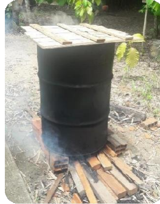
Se colocó pequeños sacos conteniendo la arena lavada, para que en el cilindro hierva en un lapso de 2 horas, para que el sustrato arena se pueda desinfectar
