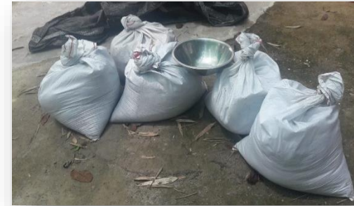
Sacos de arena desinfectados para luego vaciar en las cámaras de subirrigación e ir llenando por capas
