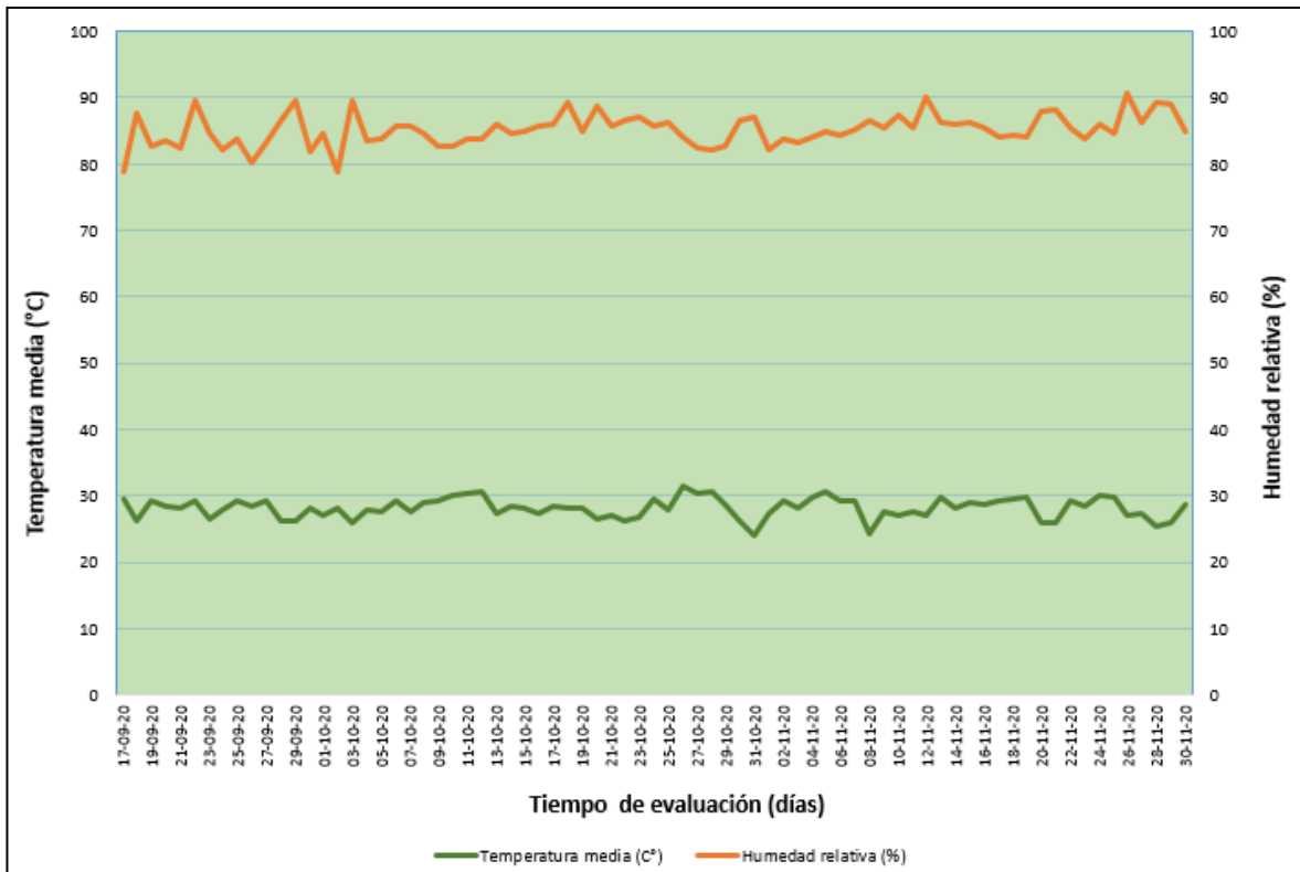
Figura 27. Variación de la temperatura media y humedad relativa media al interior de la cámara de sub irrigación durante los días evaluados para Guadua superba Huber.
