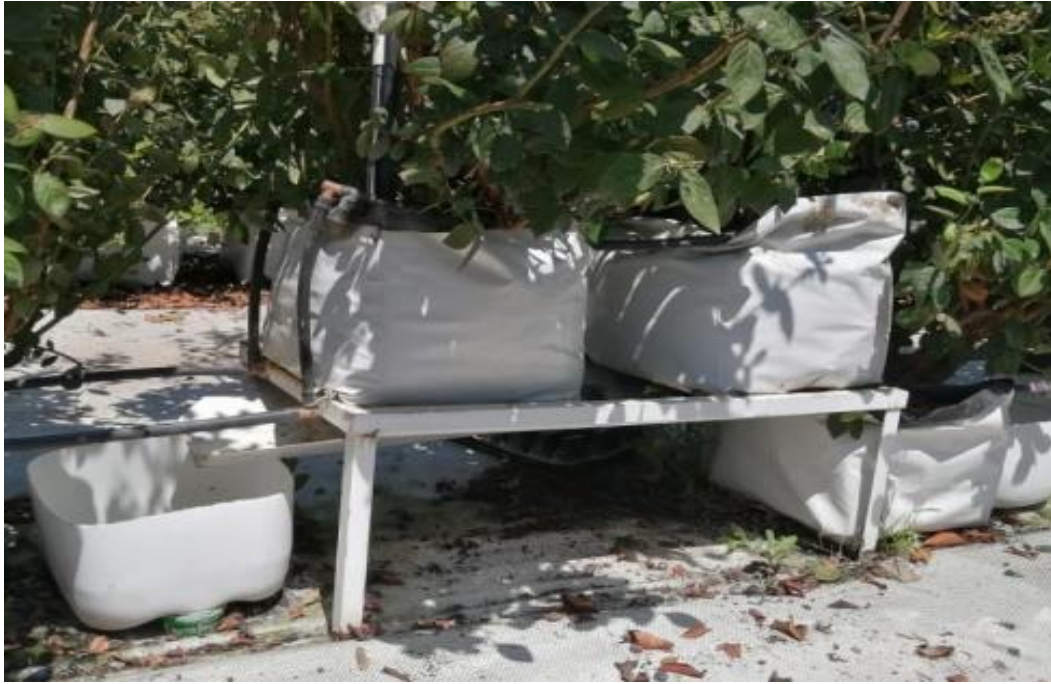
Figura 11: Lisímetro utilizado para recolectar el drenaje de agua de riego proveniente de una planta
