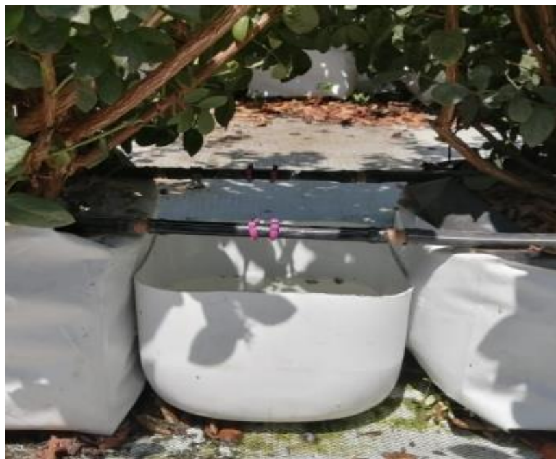
Figura 12: Gotero control utilizado para registrar la cantidad de agua suministrada a una planta mediante riego
