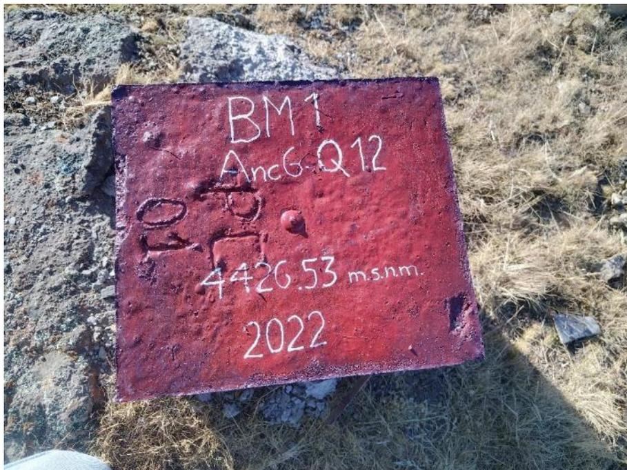
**Figura 9: Puntos de control para el trazo y replanteo de la obra**
