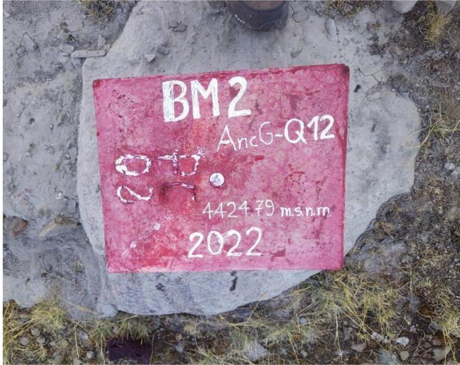
**Figura 10: Puntos de control para el trazo y replanteo de la obra**
