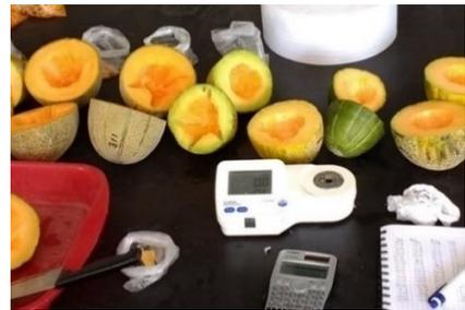
(d) Evaluación de grados Brix con refractómetro
