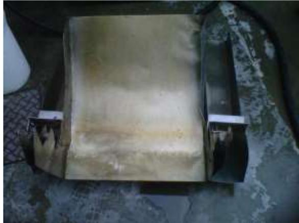
**Figura 1: Carcasa de la peladora de papas antes de la limpieza**
