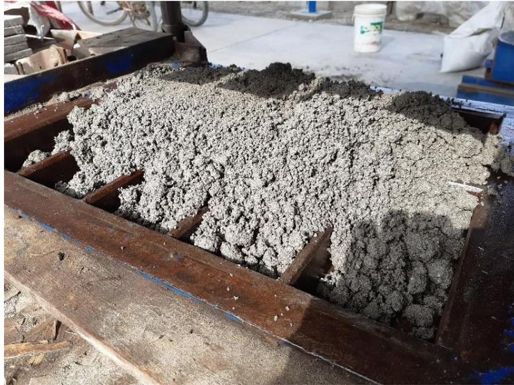
**Figura 13: Mezcla situada en el molde de adoquines**
