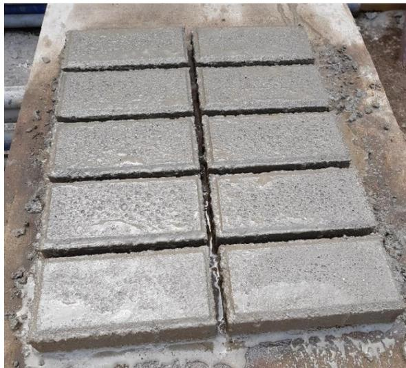
**Figura 14: Adoquines frescos retirados de la máquina adoquinera**
