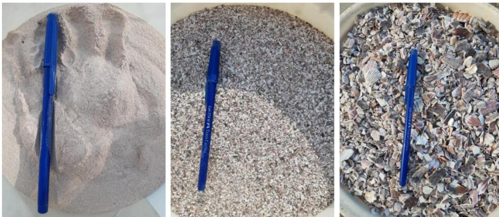
**Figura 8: RCA1 (derecha), RCA2 (centro) y RCA3 (izquierda), comparados con el tamaño de un lapicero**
