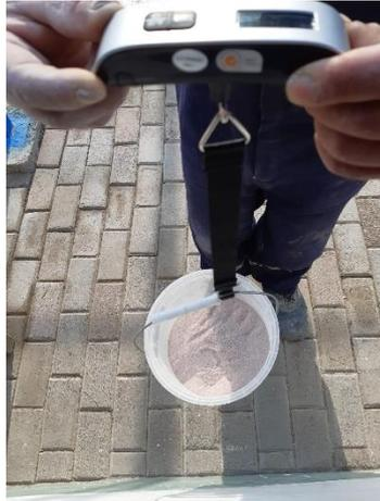
**Figura 9: Pesaje de los agregados de RCA obtenidos**
