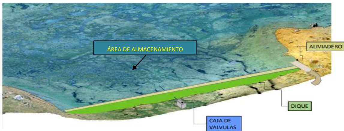
Figura 2: Componentes de un dique para qocha
