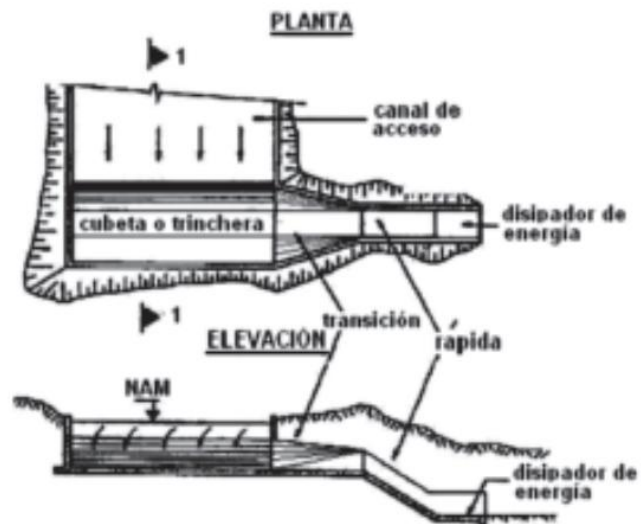
Figura 30: Componentes de un aliviadero lateral
