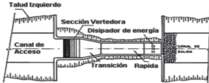
Figura 6: Componentes de un aliviadero de demasías típico
