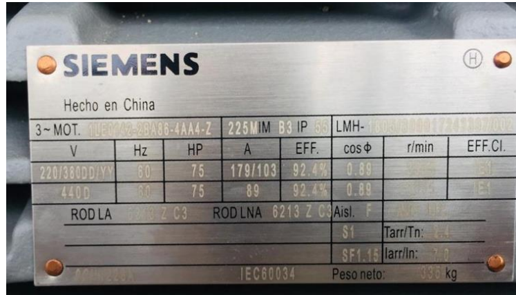
Figura 63: Placa de motor, se puede observar que para la tensión de 440V que requiere el motor, la intensidad de corriente correspondiente debe ser 89A
