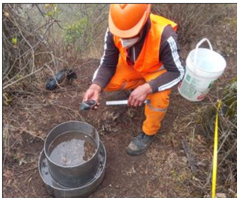
Figura 15: Prueba de infiltración en la progresiva 0+280 km.
