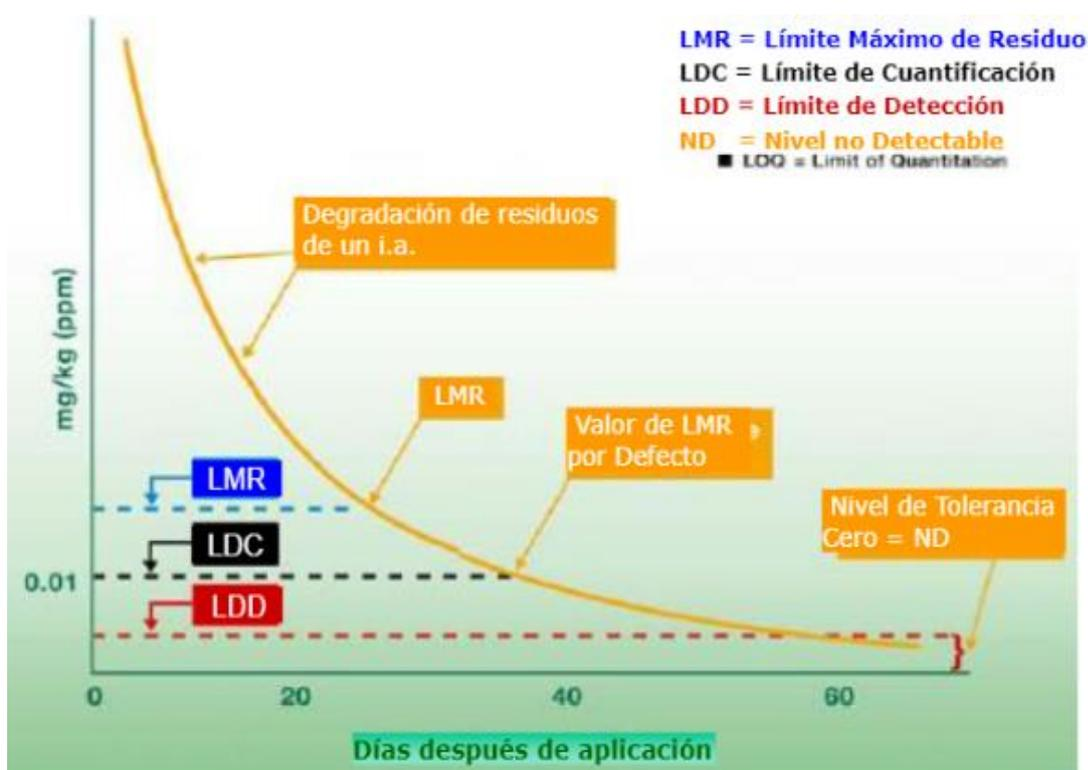
Figura 8: Puntos límites de una curva de disipación.
