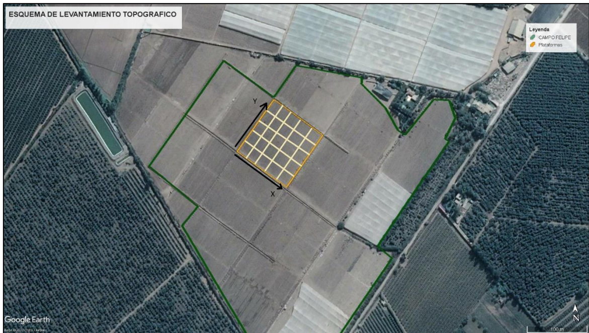
Figura 14. Enmallado en campo para levantamiento geométrico
