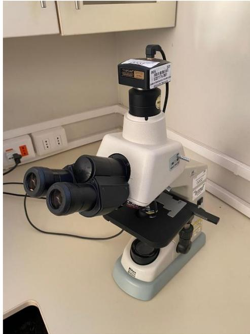
**Figura 12. Cámara fotográfica adaptada al microscopio utilizado en la evaluación**
