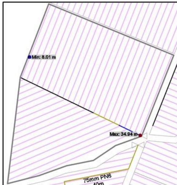
Figura 29: Presión máxima y mínima de subunidad 23 (válvula en elevación 153 m)
