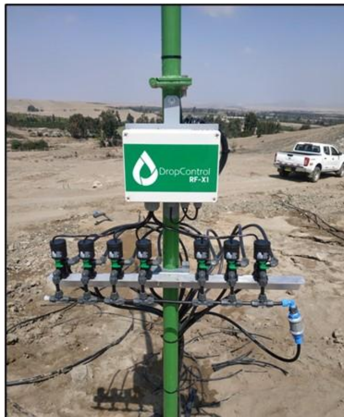
Figura 42: Nodo RF-X1 con barra de 7 solenoides BERMAD
