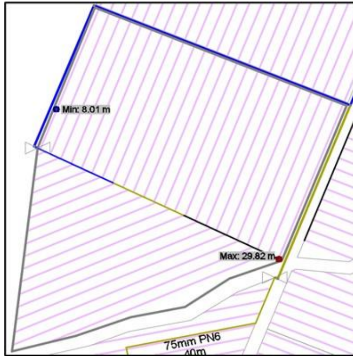
Figura 28: Presión máxima y mínima de subunidad 23 (válvula en elevación 175 m)
