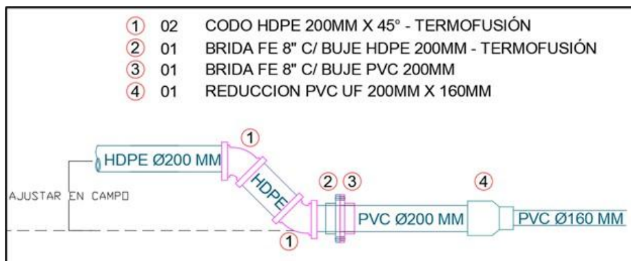
Figura 19: Esquema de conexión tubo de HDPE y PVC de 200 mm
