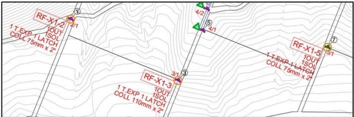
Figura 40: Ubicación de nodos RF-X1 en válvulas 1, 3 y 7
