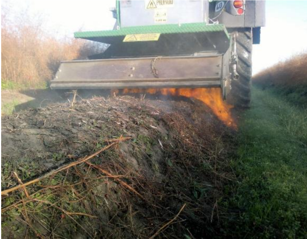
Figura 58: Pirocontrol de malezas después de la cosecha. Nótese que el control se ubica sólo dentro de la hilera de plantas y no en el corredor biológico.
