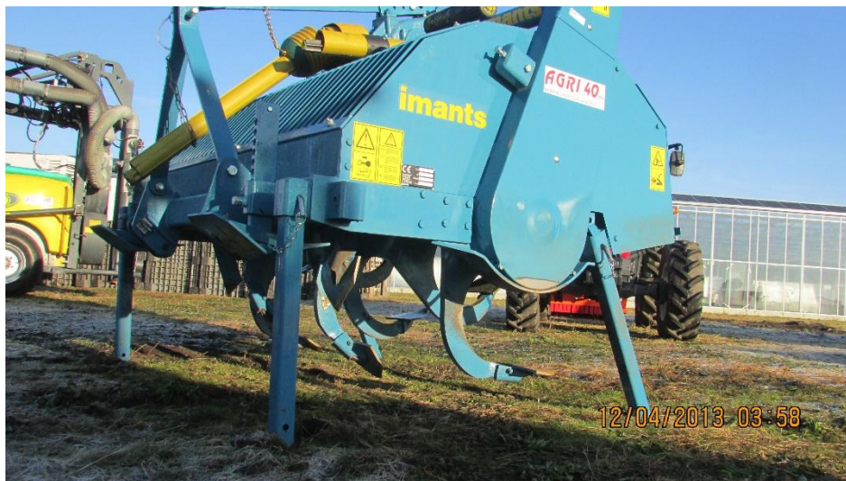
Figura 49: Incorporadora de materia orgánica. Permite incorporar la materia orgánica hasta 100 cm de profundidad.
