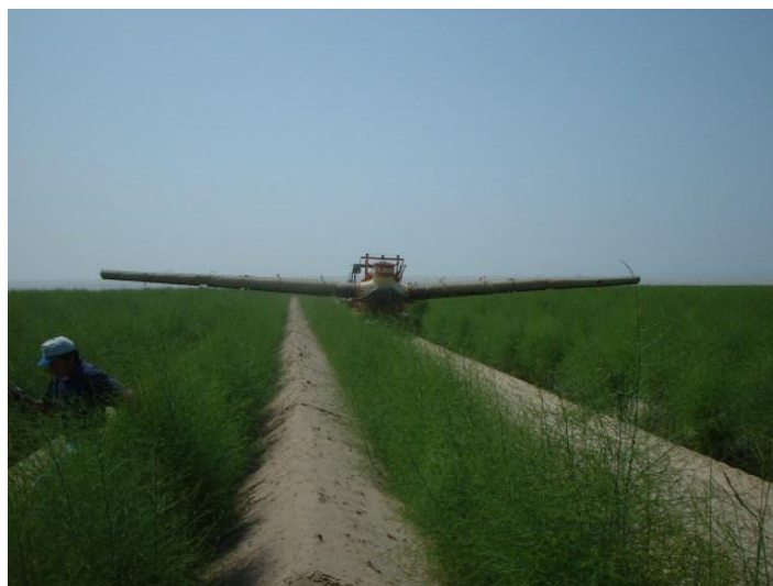
Figura 41: Aplicación de agroquímicos mediante el uso de tractor y aguilón .
