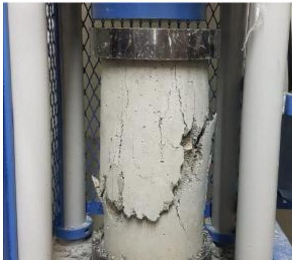
**Figura 14: Rotura de Probeta**
