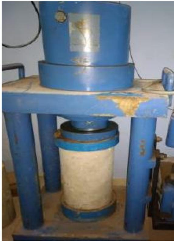
**Figura 13: Ensayo de compresión del concreto**
