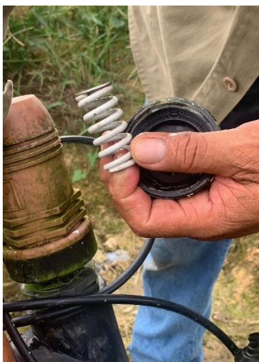
Figura 34: Resorte del piloto regulador de presión
