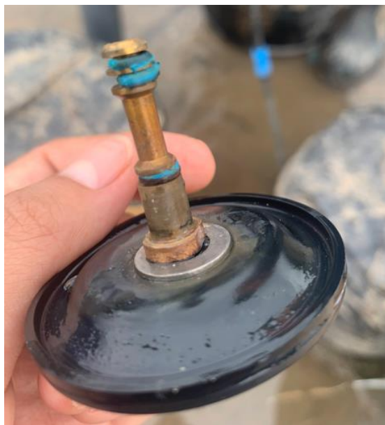
Figura 33: Diafragma del piloto regulador de presión
