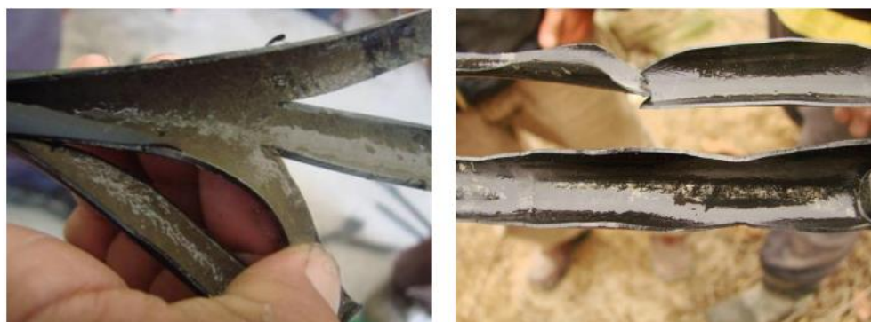
Figura 17: Comparativa de cintas de riego, antes y después del uso de pig
