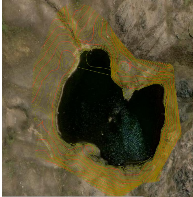
Figura 39: Curvas de nivel generadas a partir de un levantamiento topográfico con un GNSS diferencial en una qocha
