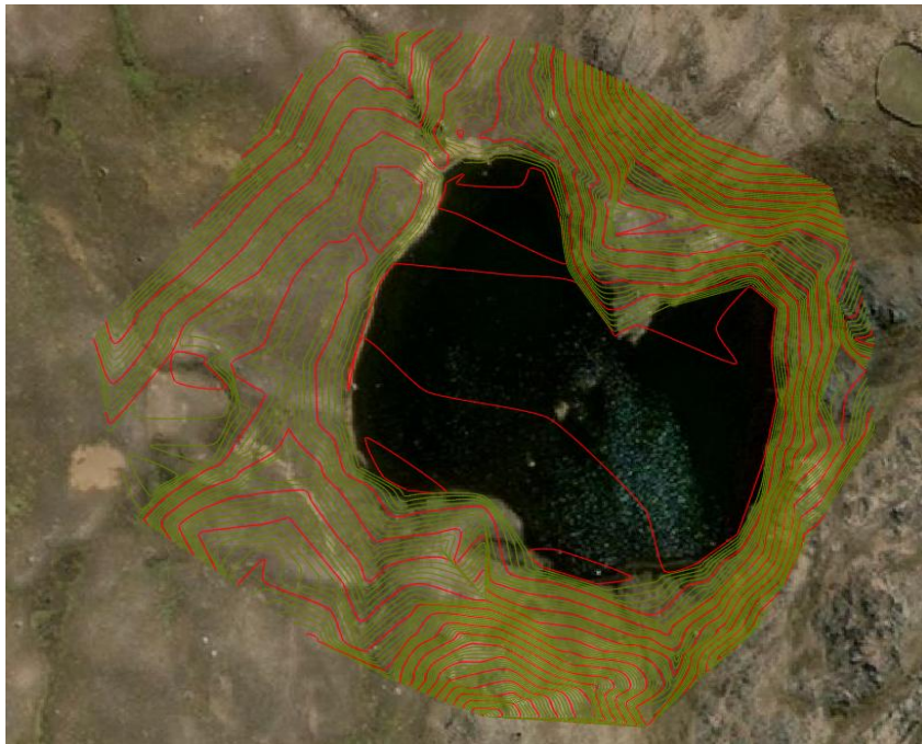
Figura 36: Curvas de nivel generadas a partir de un levantamiento topográfico con estación total en una qocha
