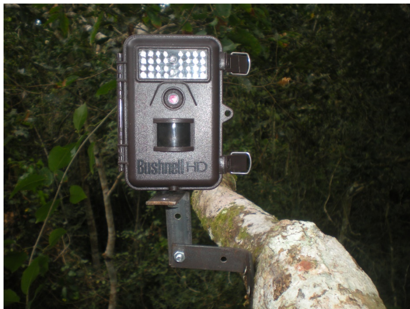
Figura 2: Cámara trampa montada en soportes en L.
