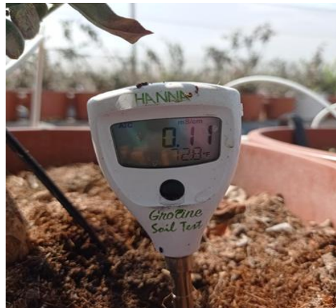
Figura 13: Muestras la toma de la lectura de la CE y pH del sustrato en el manejo de arándanos en macetas
