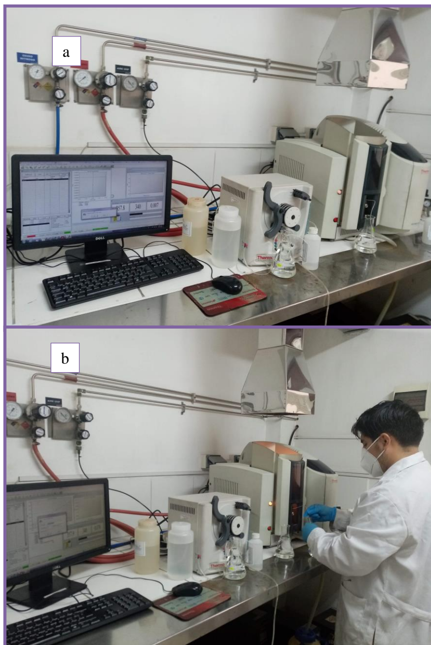
Figura 19: a) Equipo de absorción atómica Thermo Scientific iCE 3000 series b) Ensayo a llama para la lectura de Cr
