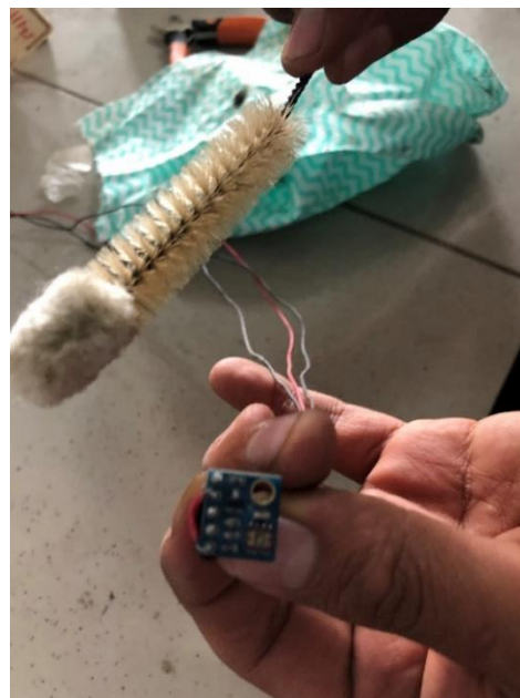
Figura 165: Limpieza de sulfatos con WD-40 del sensor ML8511.
