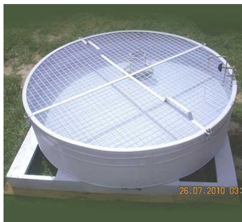
Figura 9: Tanque evaporímetro para la estimación de la evapotranspiración.
