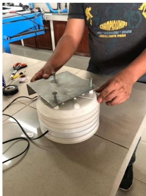
Figura 138: Ensamblaje de estructura de soporte con módulo de medición de temperatura y humedad relativa.
