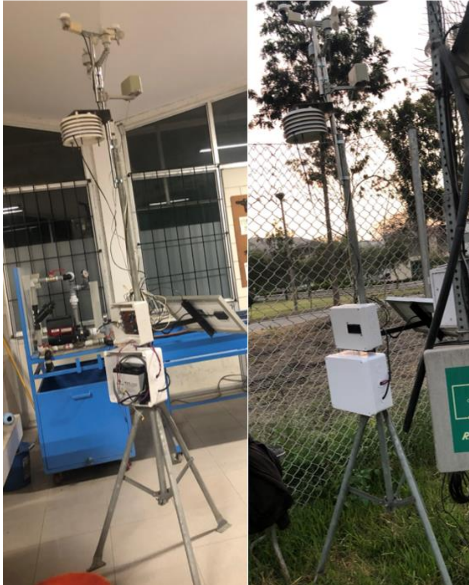
Figura 57: Vistas del prototipo: a la derecha ensamblaje en laboratorio y a la izquierda, instalación en campo.
