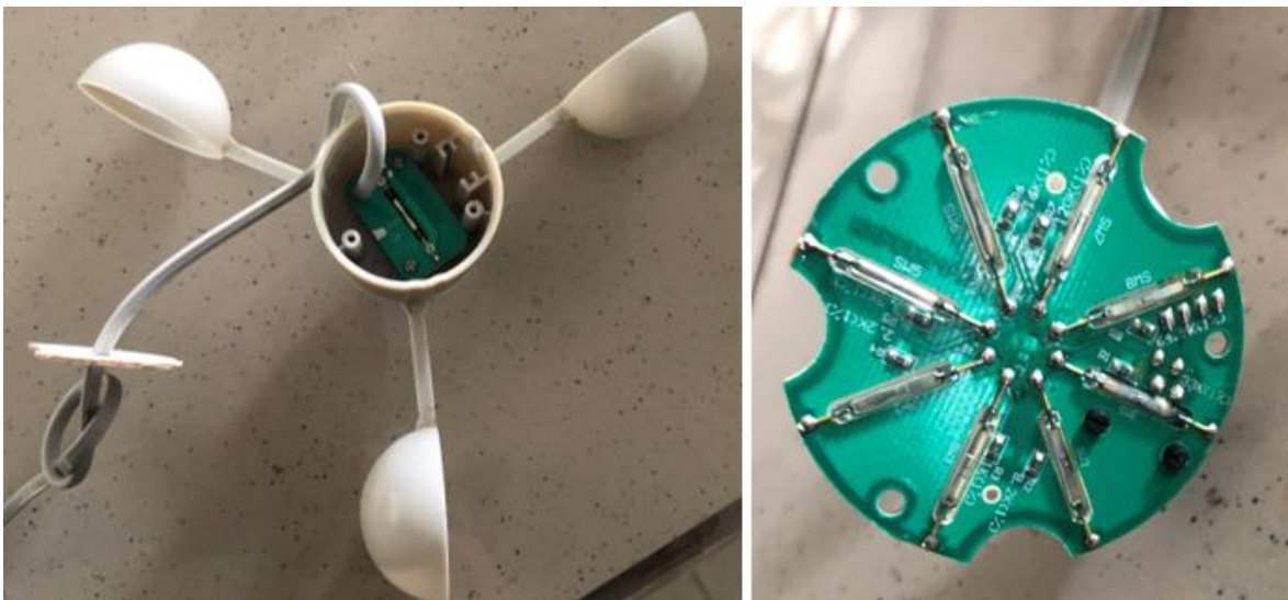
Figura 108: Vista de las placas del sensor de velocidad del viento y dirección del viento.
