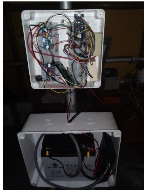
Figura 133: Primera habilitación de la unidad central de procesamiento con placas de pruebas.
