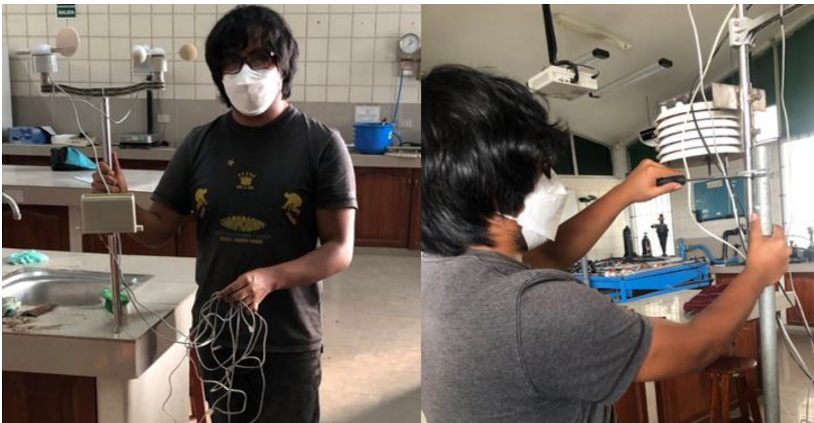
Figura 101: Módulo Weather Meters y su ensamblaje con el módulo de temperatura y humedad.
