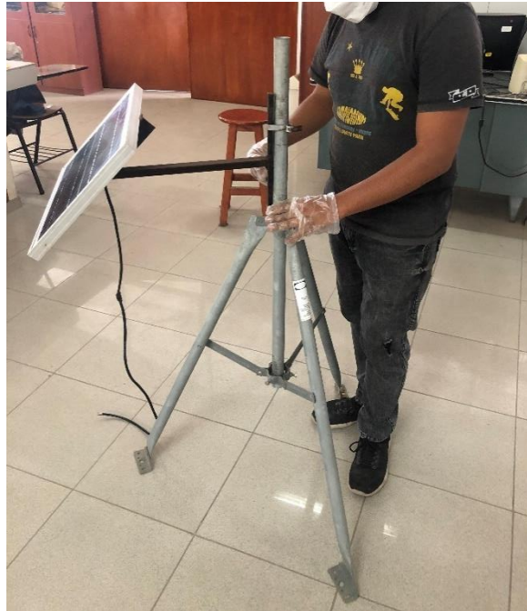
Figura 96: Panel solar, estructura del mismo y trípode.
