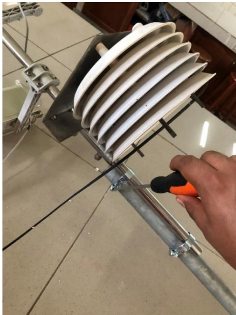
Figura 146: Ensamblaje de los módulos de temperatura y humedad, velocidad y dirección del viento, y radiación solar con mástil superior del trípode.
