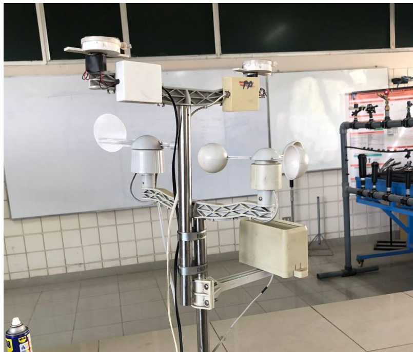
Figura 50: Estructuras de soporte de los sensores de velocidad y dirección del viento, y de radiación ML8511 y SI1145.
