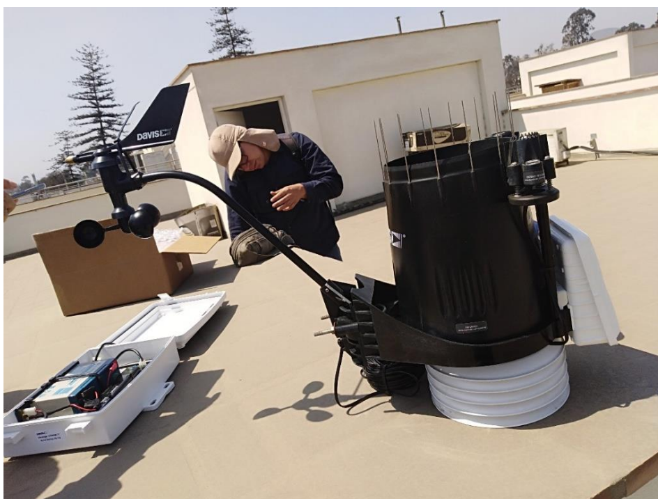
Figura 170: Mantenimiento y calibración estación meteorológica de referencia Davis Vantage Pro2 de la FIA por parte del personal de la empresa Davis Instruments, en la UNALM.
