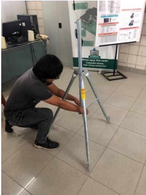
Figura 122: Ensamblaje del trípode para montar la estación.
