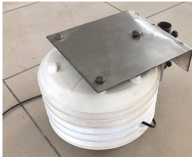
Figura 47: Abrigo meteorológico contenedor del sensor de temperatura y humedad.
