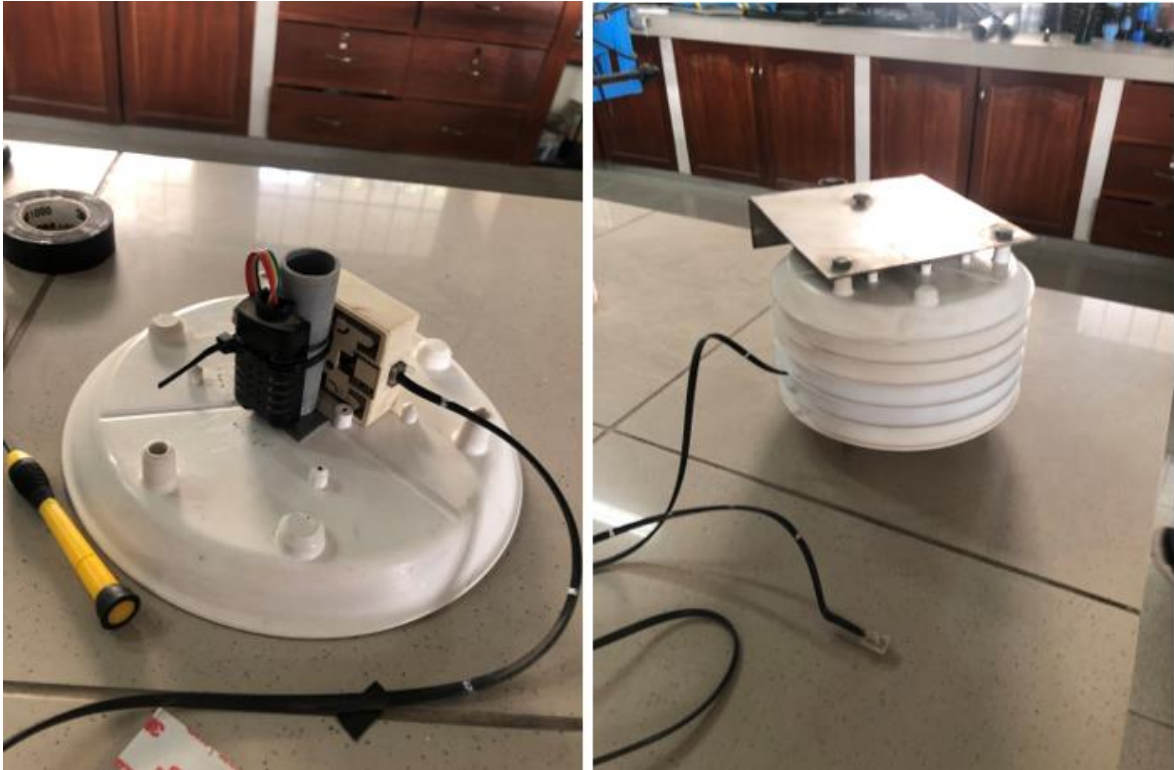
Figura 100: Vista interior y final del módulo del sensor de temperatura y humedad.
