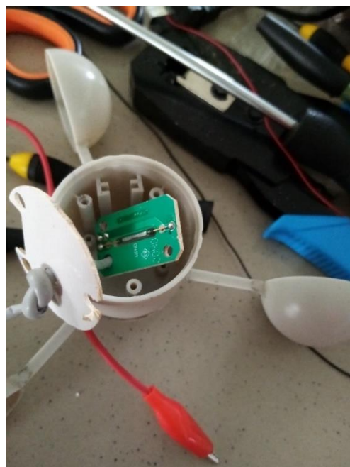
Figura 136: Verificación eléctrica de PCB del anemómetro.
