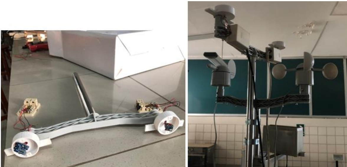
Figura 102: Módulo piranómetro o de radiación solar y ensamblaje con el módulo Weather Meter.
