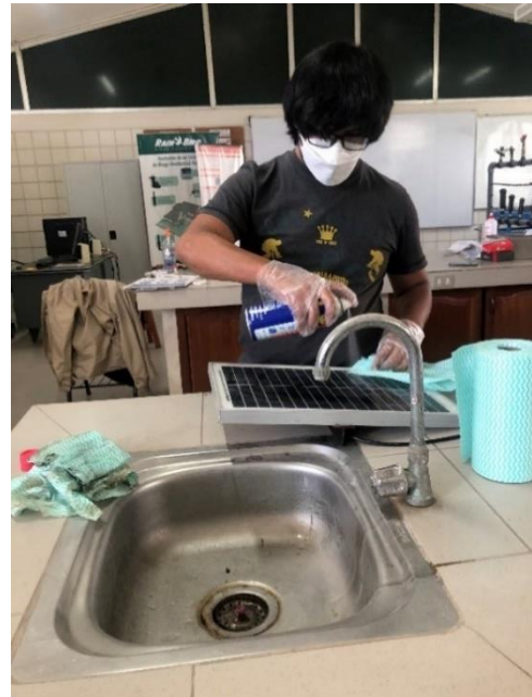
Figura 162: Mantenimiento y limpieza del sistema fotovoltaico.
