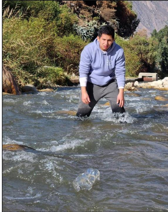
**Figura 48: Aforo por el método del flotador**
