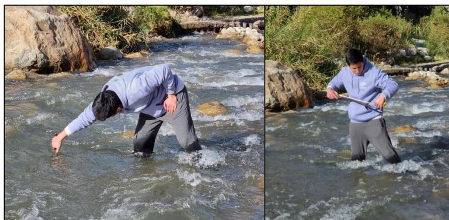
**Figura 47: Medición de tirante en el río Lullán**
