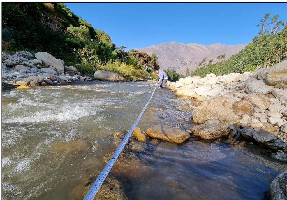
**Figura 76: Uso de wincha para la medición de longitud de la sección de aforo**
