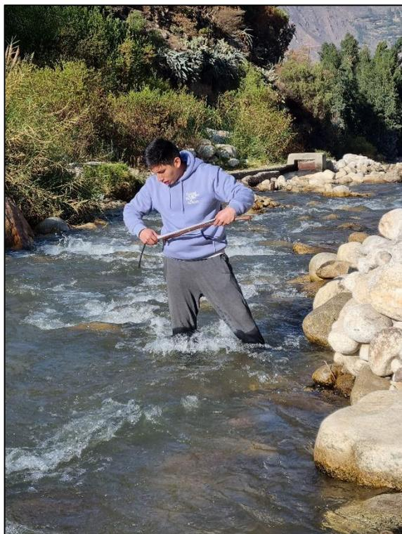
**Figura 79: Uso de Wincha para la medición de tirante en la sección de aforo del río Lullán**
