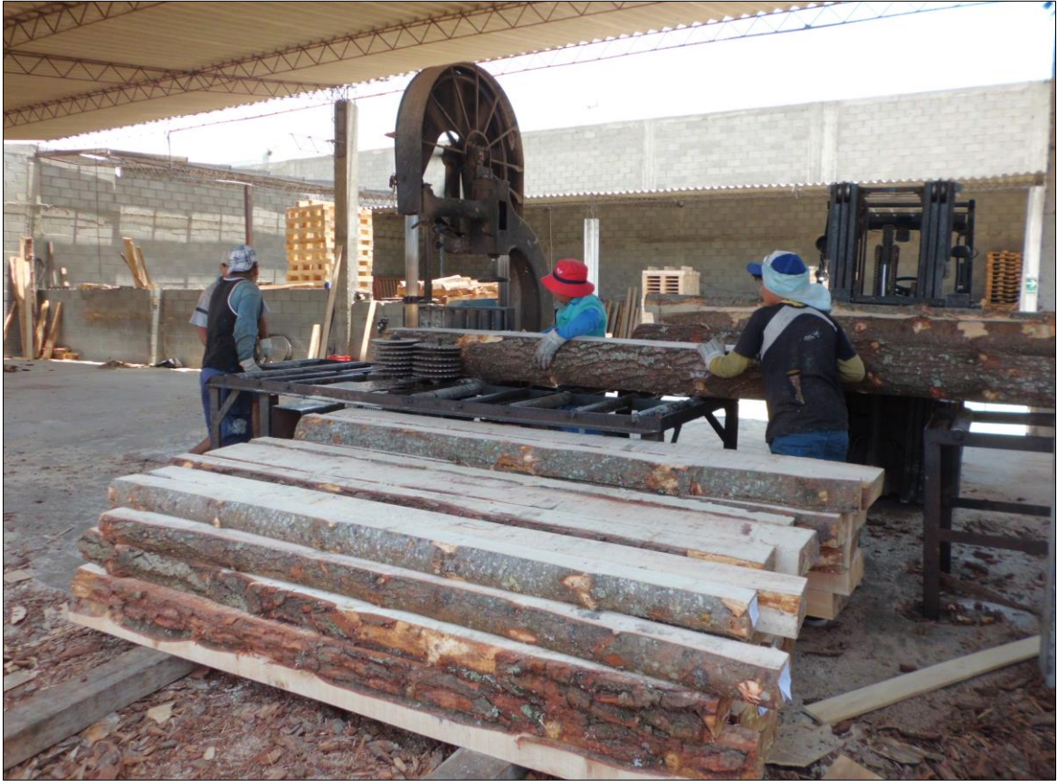
Anexo 21. Proceso de aserrado en Sierra de Cinta en el proceso de formación de “Cubo” de Pino radiata.
