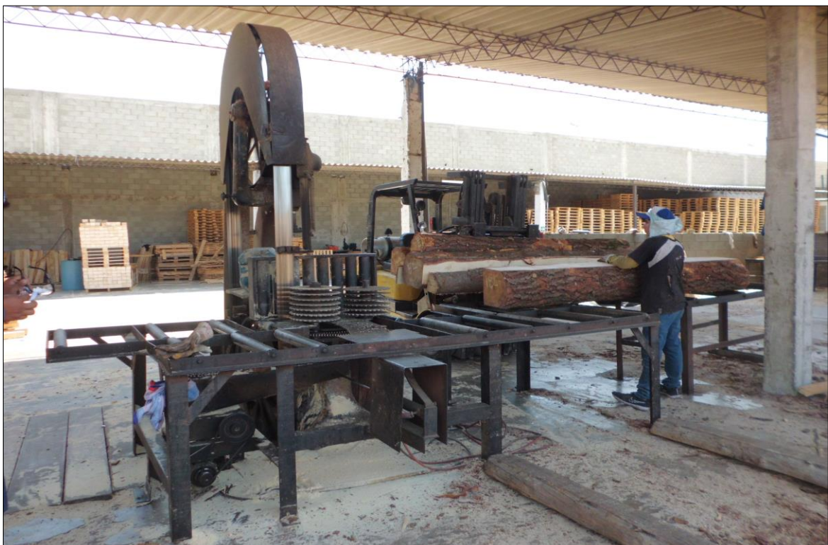
Anexo 20. Proceso de aserrado en Sierra de Cinta en el proceso de formación de “Tablon” de Pino radiata.
