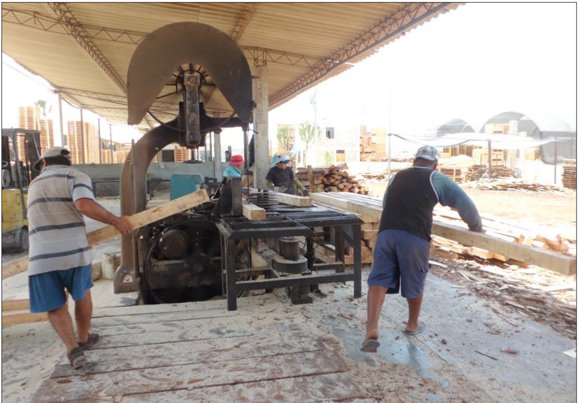
Anexo 21. Proceso de aserrado en Sierra de Cinta en el proceso de formación de “Cubo” de Pino radiata.
