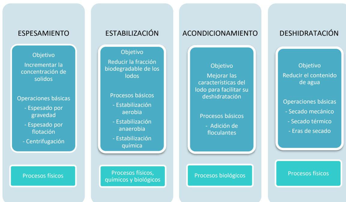
**Figura 1: Etapas de tratamiento de lodos del agua residual, ordenadas secuencialmente de izquierda a derecha.**
