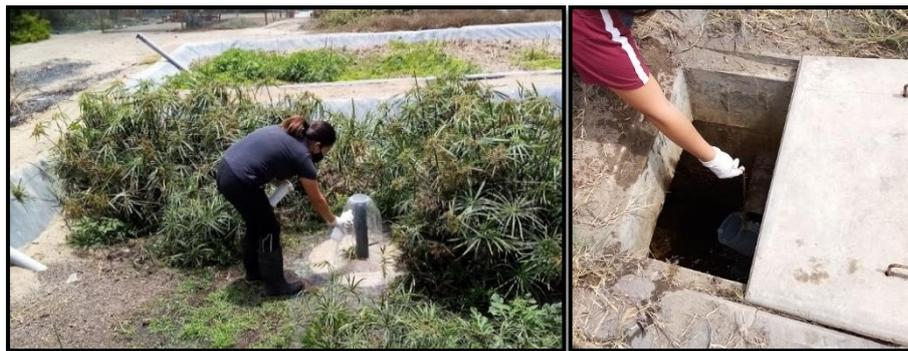
**Figura 26. Toma de muestra de agua residual cruda en celda francesa (P1) y agua residual pretratada que ingresa a la EB2 (P2).**
