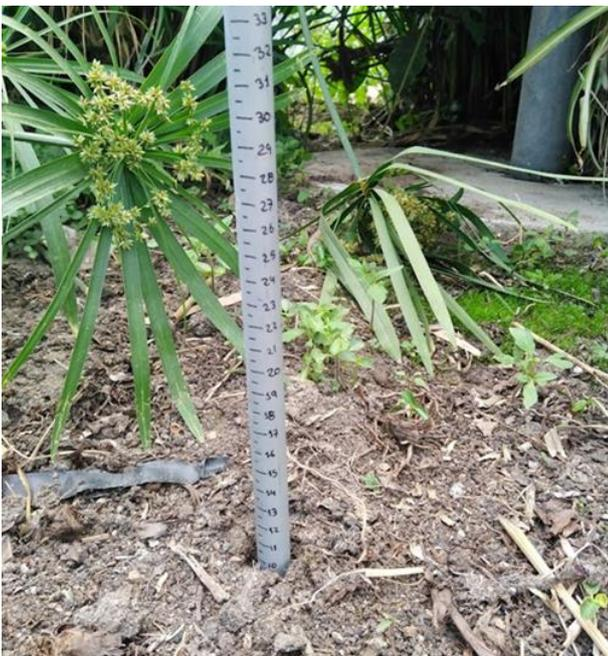
Foto 14. Medición de la altura de capa de lodos.
