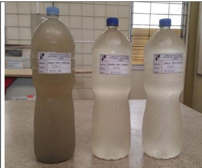
Foto 18. Muestras de agua residual. De izquierda a derecha: agua residual cruda, agua residual pretratada y efluente final.
