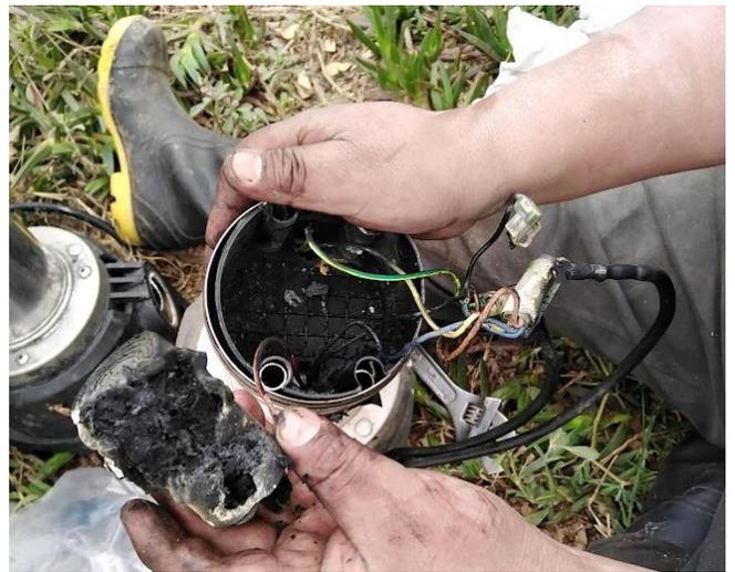
Foto 4. Capacitor de bomba quemado.
