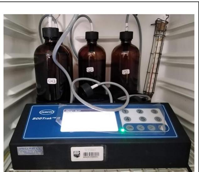
Foto 19. Uso de BODTrak para la determinación de la DBO<sub>5</sub> en cada punto de monitoreo.
