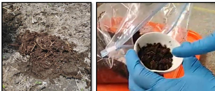
**Figura 39. Composición del lodo acumulado. A la izquierda, lodo sobre superficie de celda francesa y a la derecha, una muestra aleatoria del lodo acumulado antes de ser analizado.**
