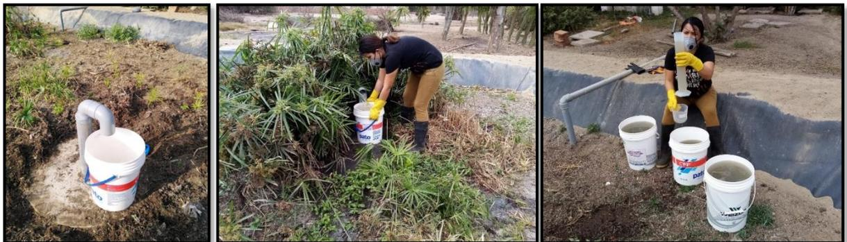
**Figura 24. Medición de caudal al ingreso del sistema**
