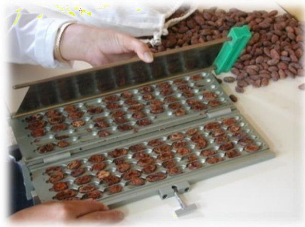
Figura 5. Prueba de corte para evaluar la calidad del grano fermentado y seco de cacao – CEPROAA –Amazonas
