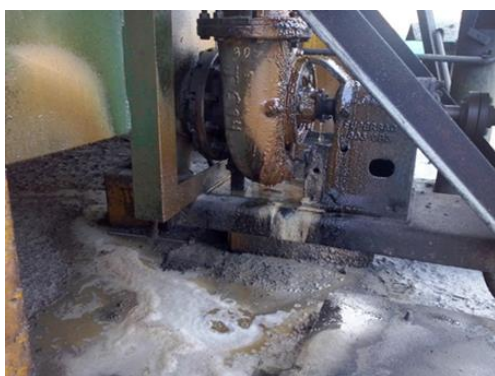
Figura 11: Bombas de difusor con fugas de jugo crudo
