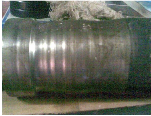
Figura 17: Bocina desgastada de bomba de circulación
