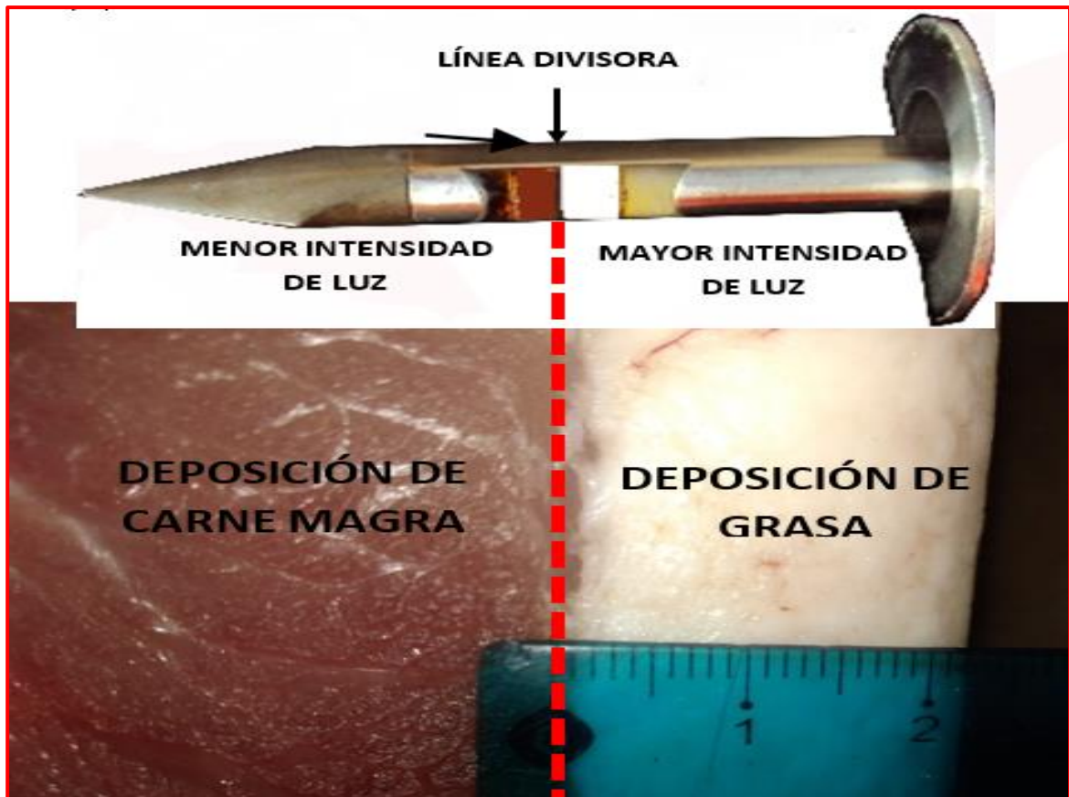
Figura 6: Determinación del espesor de grasa dorsal
