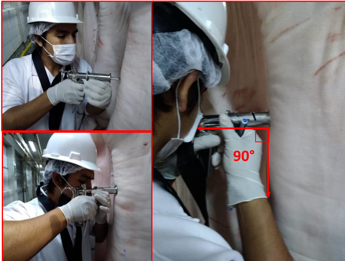
Figura 5: Inserción de punta del introscopio
