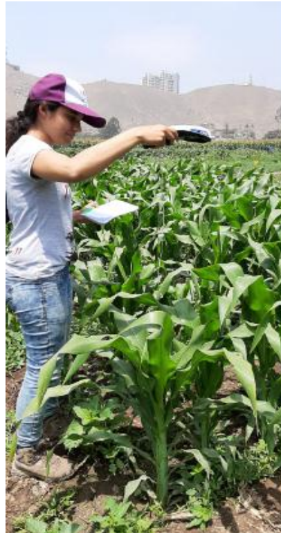
Figura 4: Medición de NDVI con el sensor GreenSeeker
