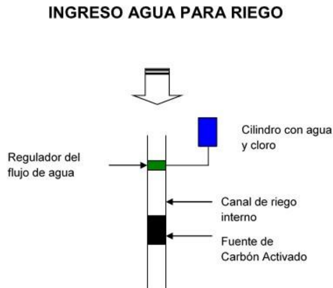
Figura 28. Diseño para el tratamiento del agua que ha superado los límites microbiológicos permisibles.
