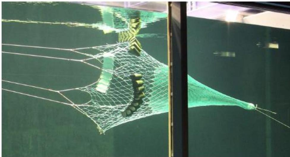
Figura 14. Modelo de prototipo de red de arrastre pelágica para muestreo (Tomado con permiso de los autores Breen *et al.*, 2012).
