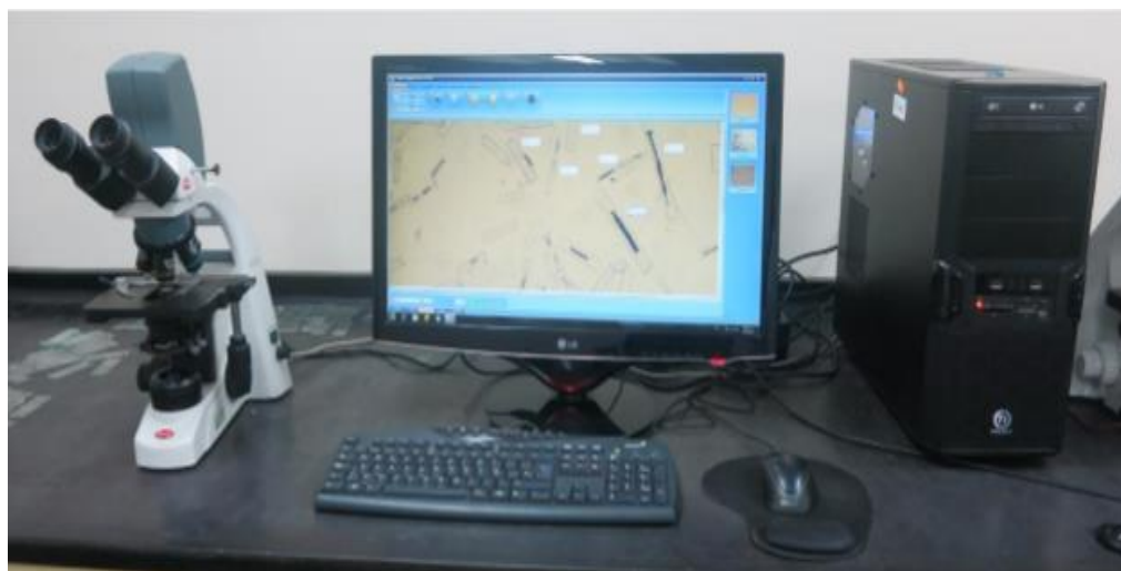
Figura 10. Medición de diámetro por tipo de médula en fibra de alpaca usando microscopio de proyección (Software MOTIC®) en el Laboratorio de Fibras Textiles, Pieles y Cueros “Alberto Pumayalla Díaz”.
