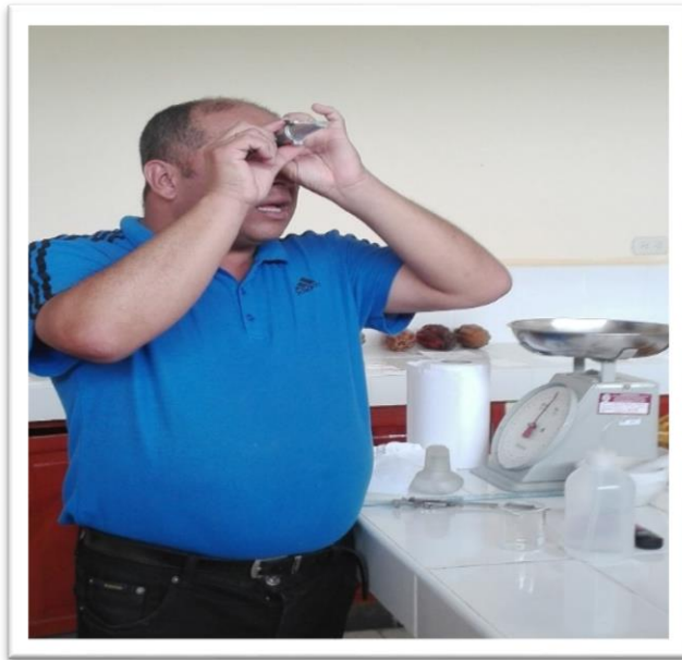
Lectura de °Brix en refractómetro
