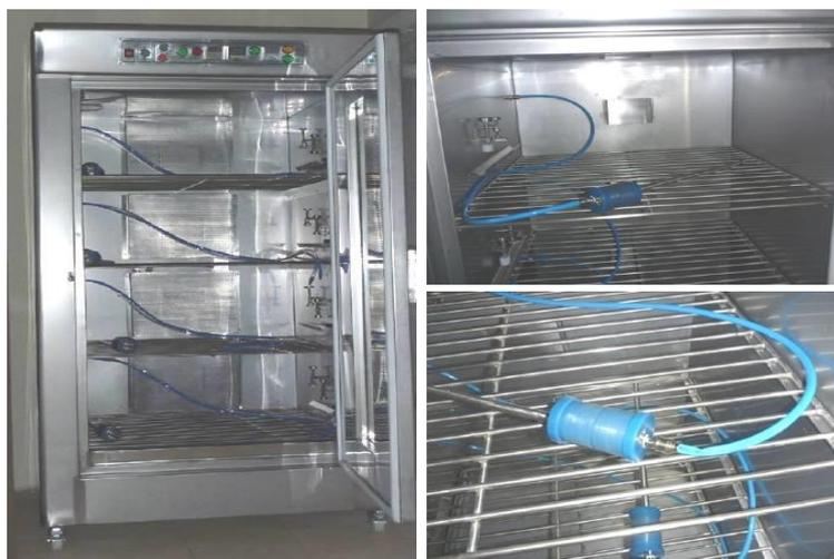
**Figura 9.** Cabina de esterilización de óxido de etileno A400. La cabina A400 tiene cuatro rejillas y cuatro sistemas de aireación, cuatro pirómetros y 4 resistencias.
