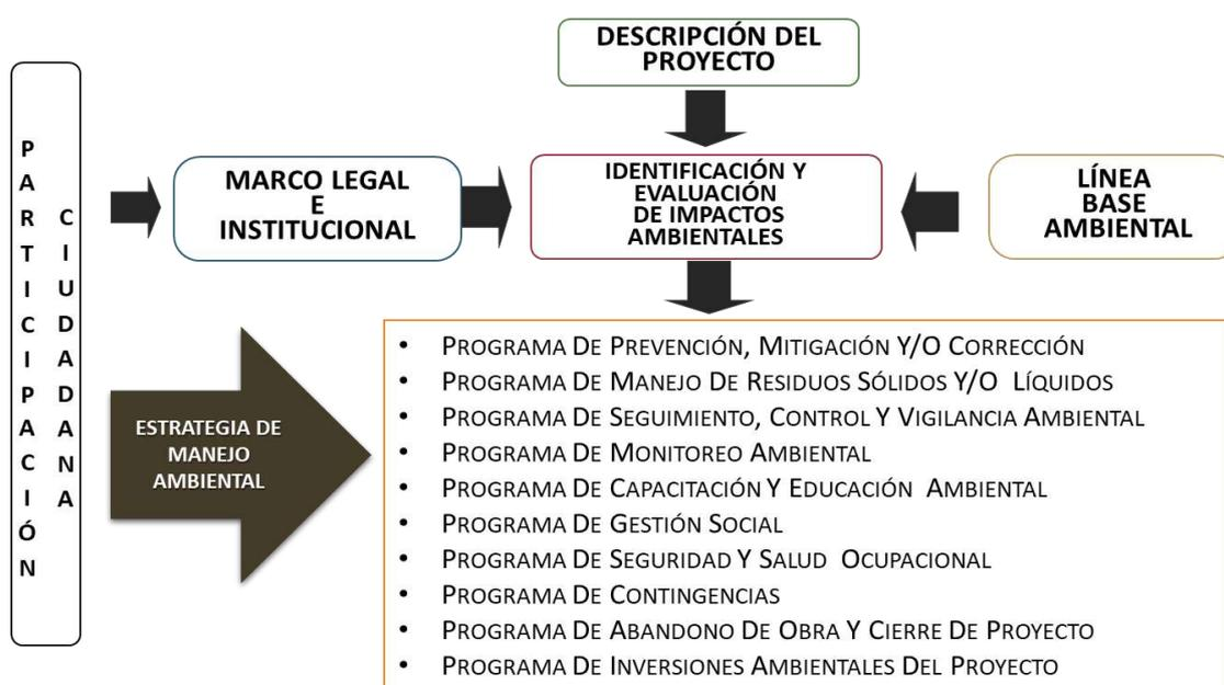
**Figura 5:** Esquema General del EIA -SD
