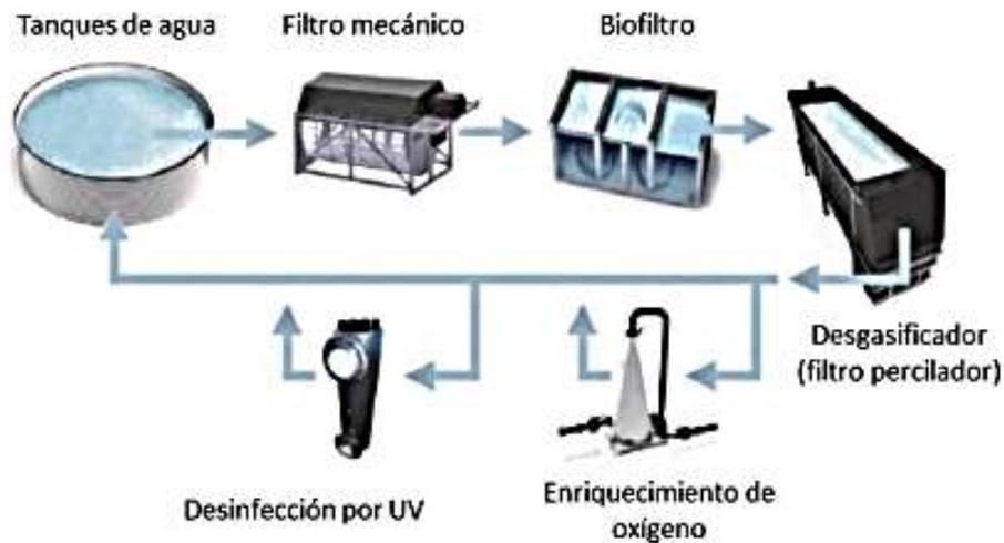
**Figura 1: El tratamiento básico del agua en un sistema de recirculación.**
