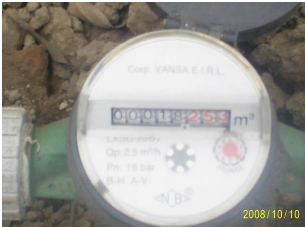
**Caudalímetro utilizado en el experimento**
