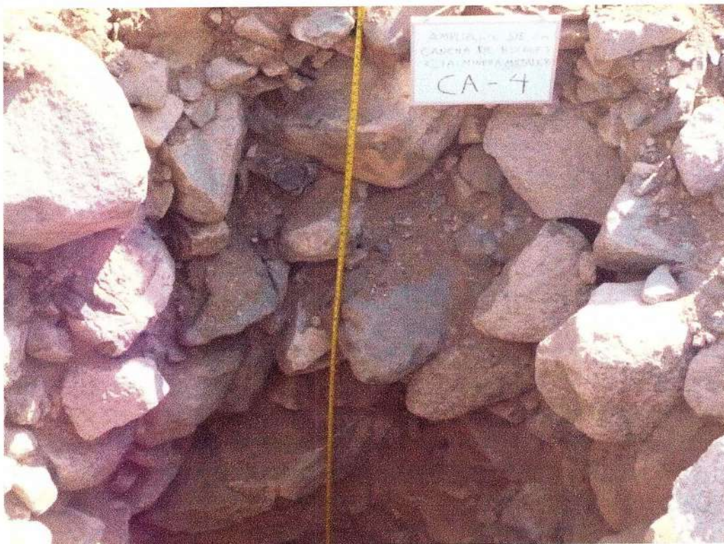
Fotografía N° 07: Vista de la Calicata CA-4 ubicada en la cimentación de la ampliación del depósito de relaves. Se observa la presencia de limos en las capas superficiales, arena limosa en niveles intermedios y grava mal gradada con presencia de bolonería entre 0.20 – 0.30 m.
