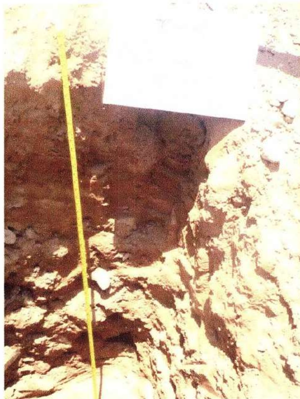
Fotografía N° 21: Vista de la Trinchera T-4 ubicada en el talud del depósito de relaves en operación. Se observa la presencia de limos en las capas superficiales con lentes de arcilla, arena limosa y bolonería de 20 a 30 cm en los niveles inferiores.
