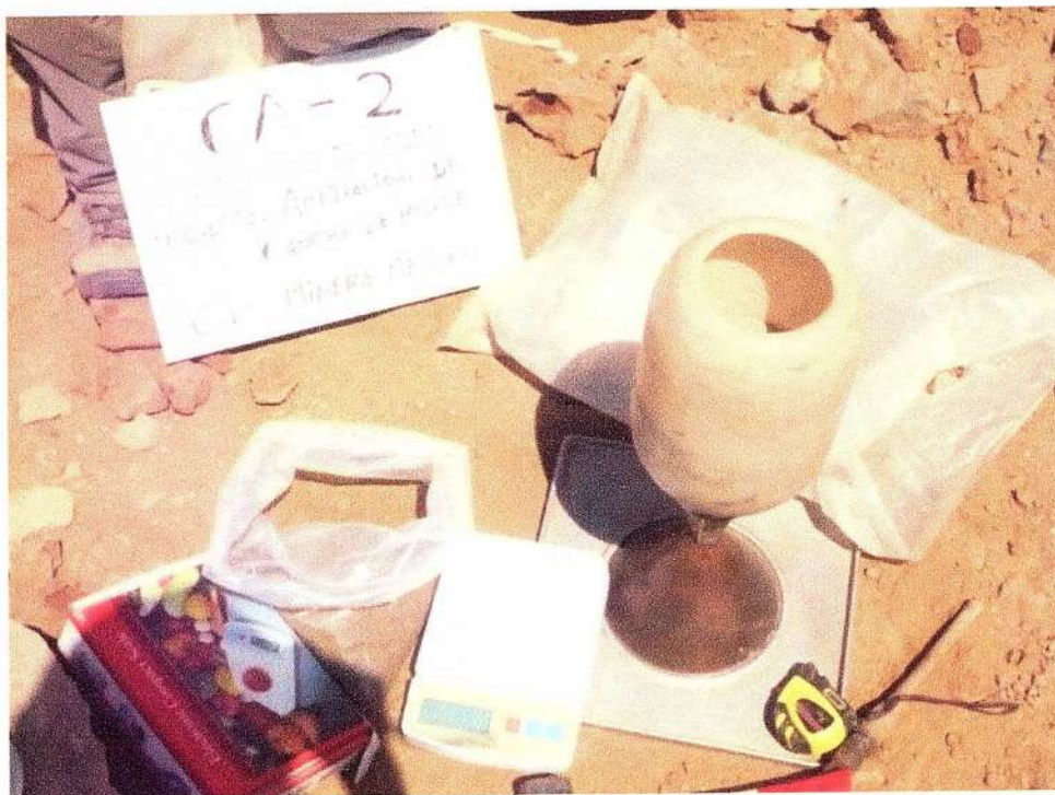
Fotografía N° 05: Calibración de equipos y ejecución de la prueba de densidad de campo en la Calicata CA-2.
