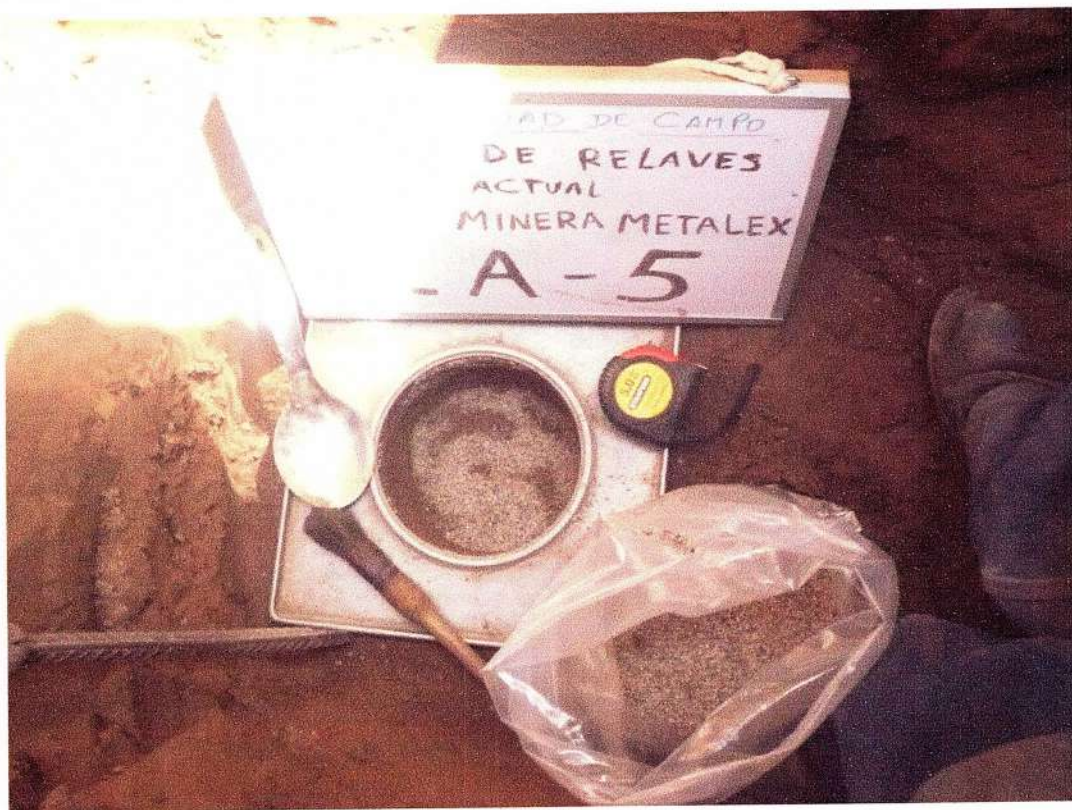
Fotografía N° 09: Calibración de equipos y ejecución de la prueba de densidad de campo en la Calicata CA-5 ubicada en la corona del depósito de relaves en operación.
