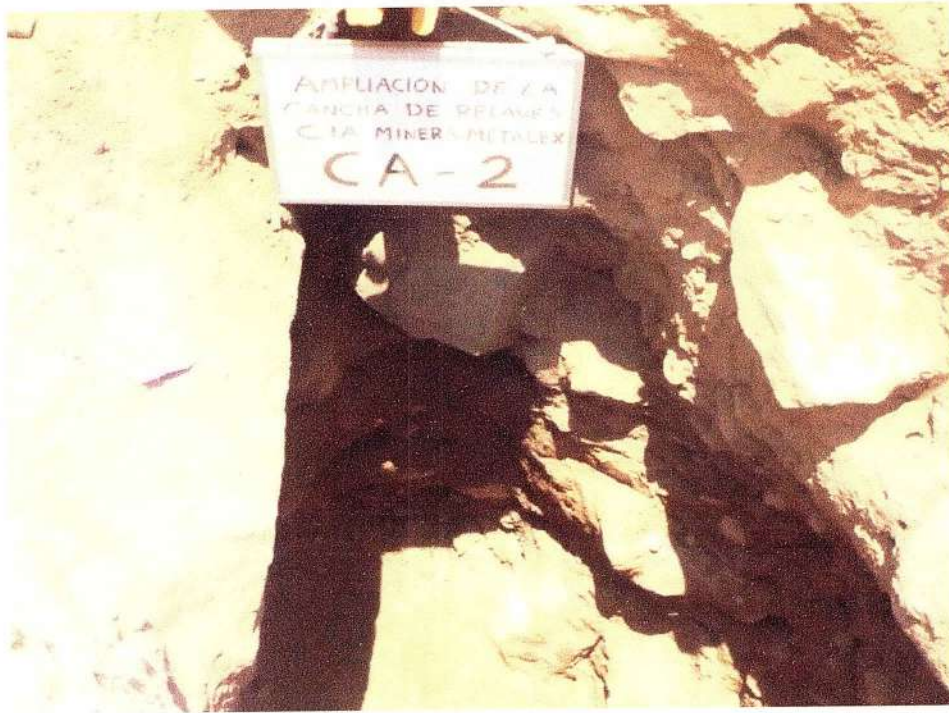
Fotografía N° 04: Vista de la Calicata CA-2 ubicada en el nivel intermedio del antiguo depósito de relaves. Se observa la presencia de arena limosa y bolonería entre 0.30 -0. 40 m.
