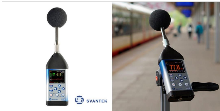
Figura 4. Sonómetro de clase 1 FUENTE: Tomado de SVANTEK (2020).
