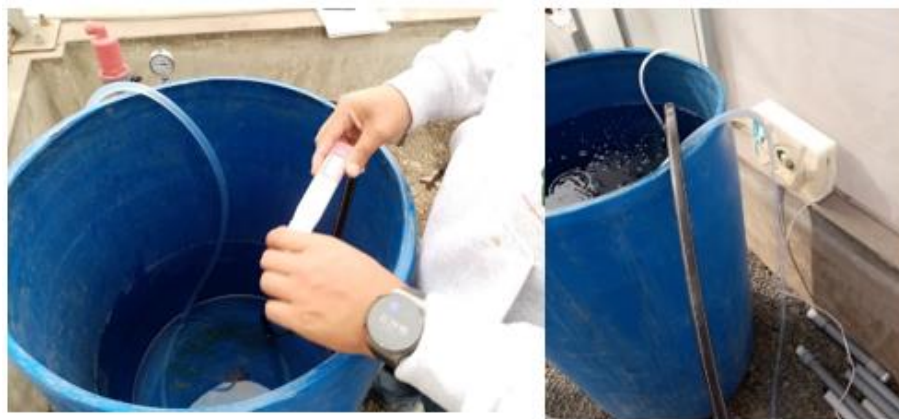
Figura 13: Medición de conductividad eléctrica en el fertirriego (Izquierda) y aplicación de ozono(derecha)
