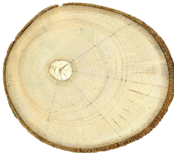
Figura 8: Rodaja de la madera de Ochroma pyramidale , escaneada a una resolución de 1200 dpi
