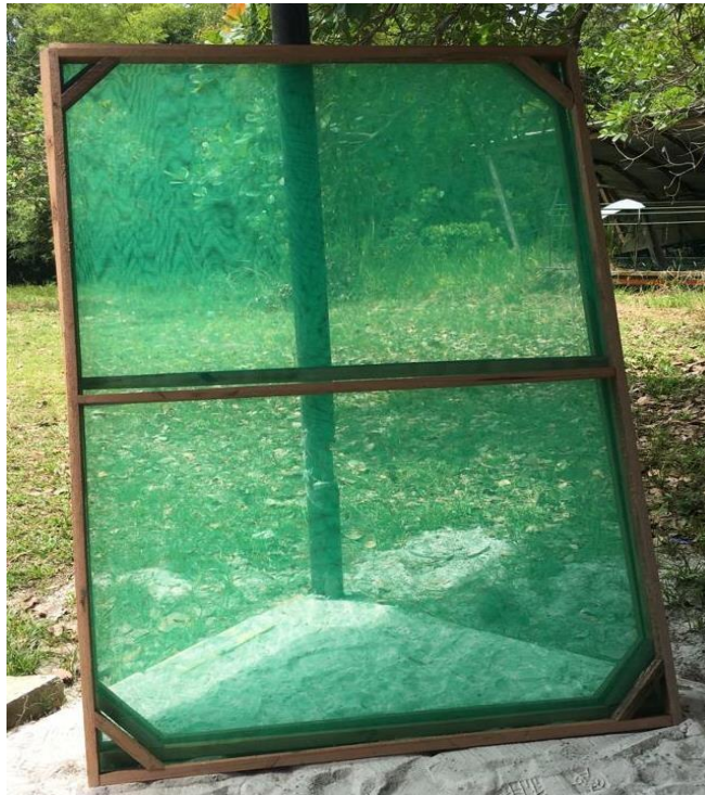
Anexo 5: Tapas de madera y malla para cada uno de los tanques experimentales.
