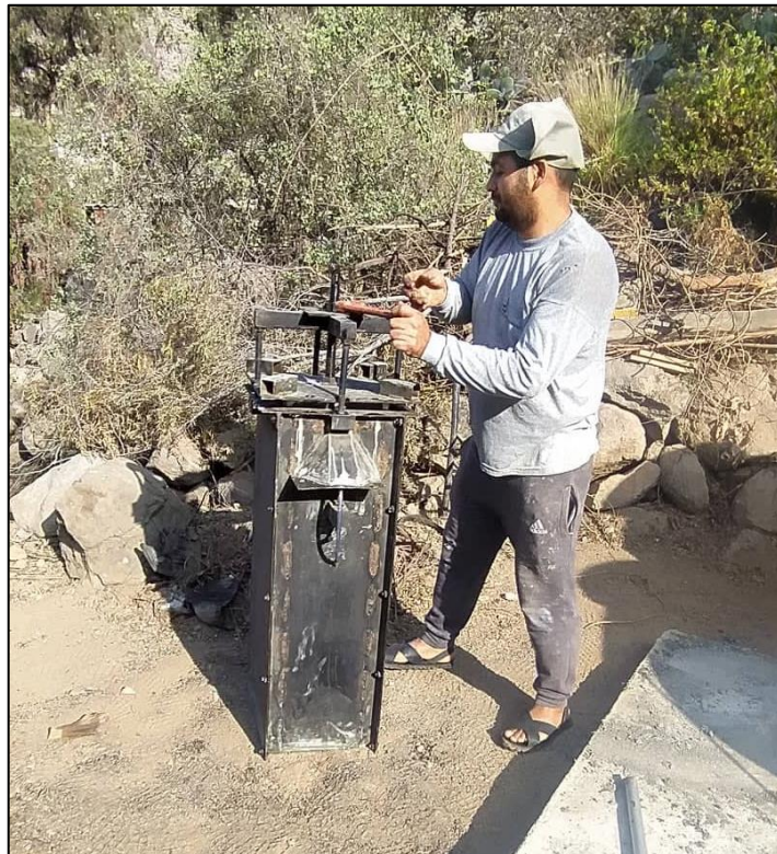
Figura 23: Molde de acero para fabricación del FBA
