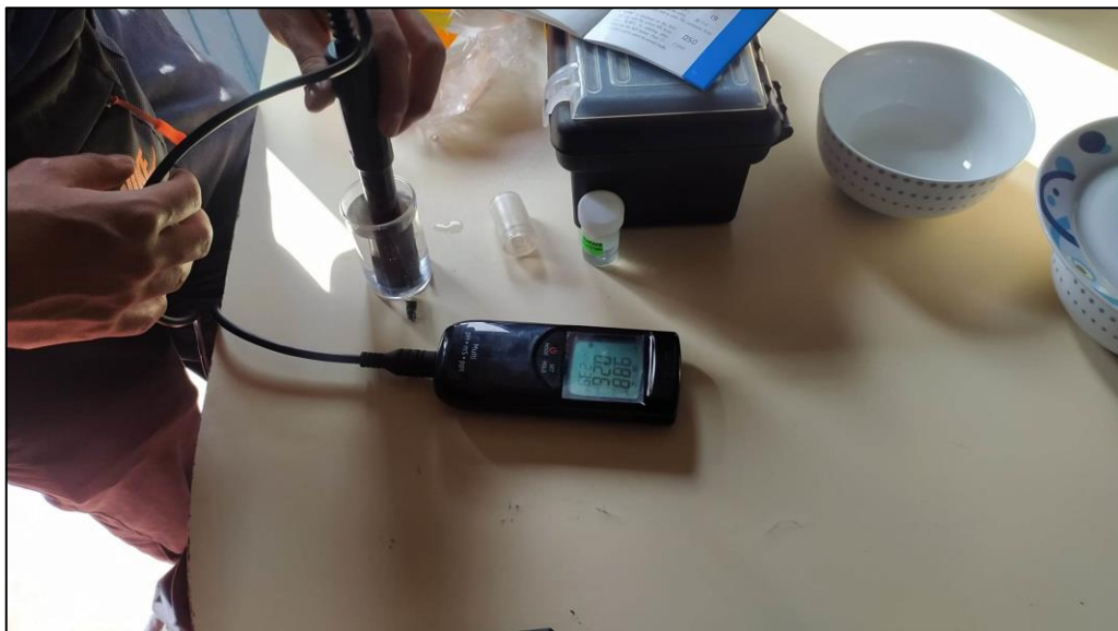
Figura 36: Medición de parámetros con Medidor HI991301 in situ
