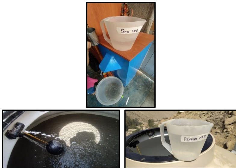
Figura 38: Medición de Caudal del filtro domiciliario (FBA) y filtro intermitente (FLAI)
