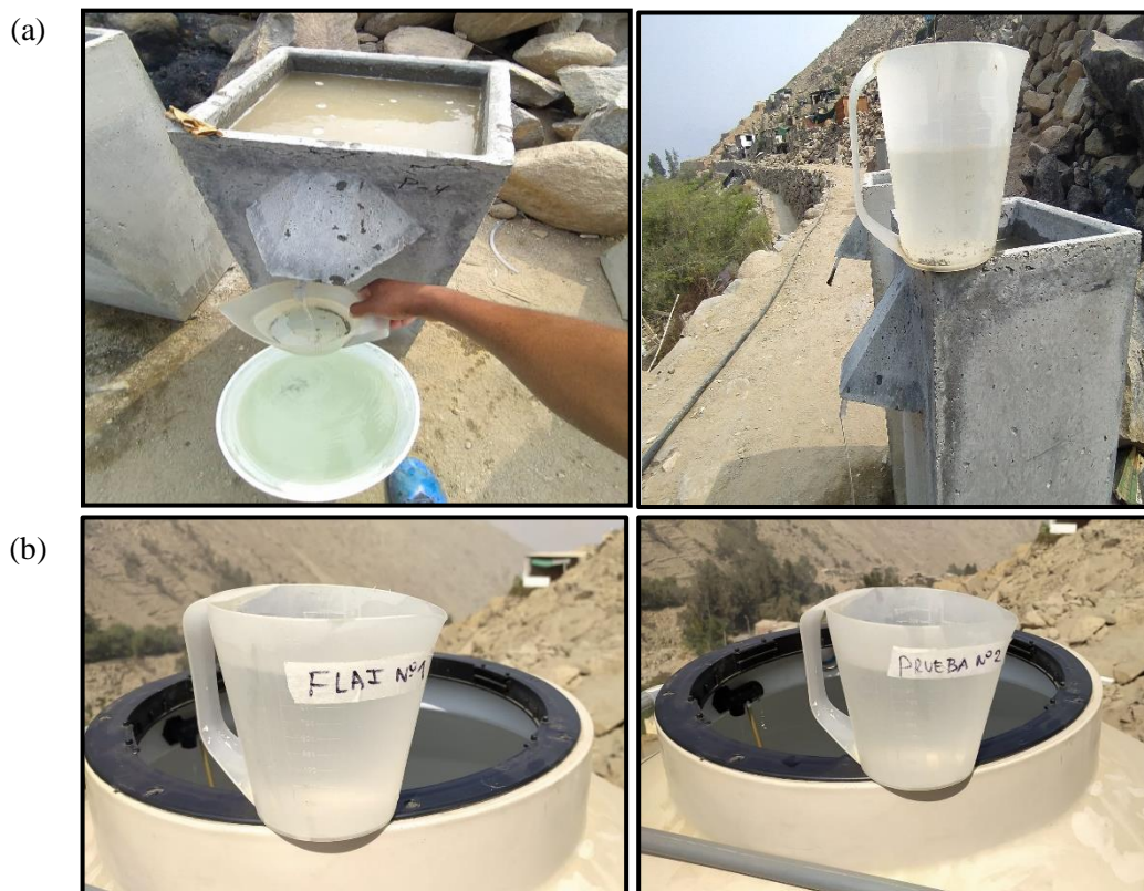
Figura 35: Vista de: (a) Medición de caudal a la salida del filtro FBA, (b) Medición de caudal a la salida del FLAI
