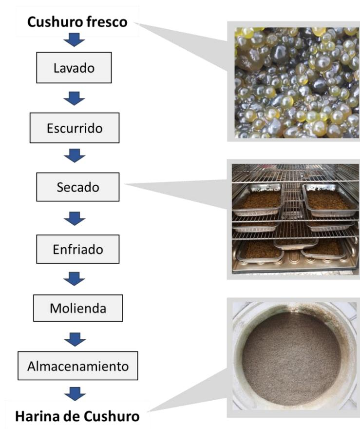
**Figura 8: Diagrama del procesamiento del cushuro fresco hasta la obtención de la harina de cushuro**
