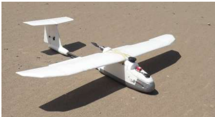
Figura 5. Vista general del dron de ala fija, tipo Skywalker
