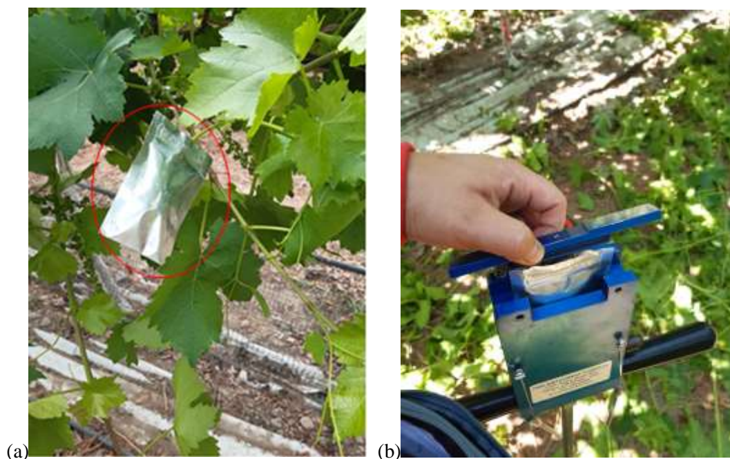
Figura 9. Vista general de (a) ubicación de las bolsas de plástico aluminizado usadas para medir el potencial hídrico, dentro de la parcela experimental (b) colocación de la muestra foliar dentro de la cámara Scholander PMS de bombeo manual
