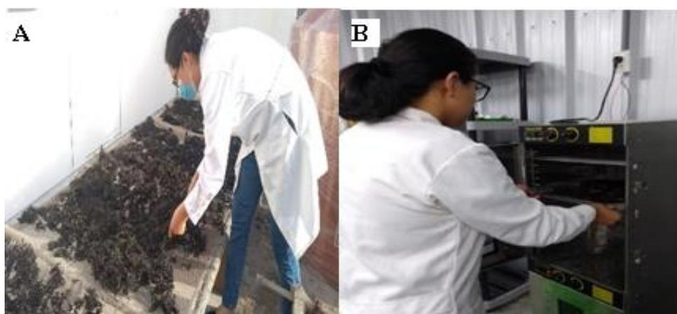
**Figura 15:** Proceso de secado de la materia prima. (A) Secado al sol en mallas, (B) Secado final en una estufa a 40°C
