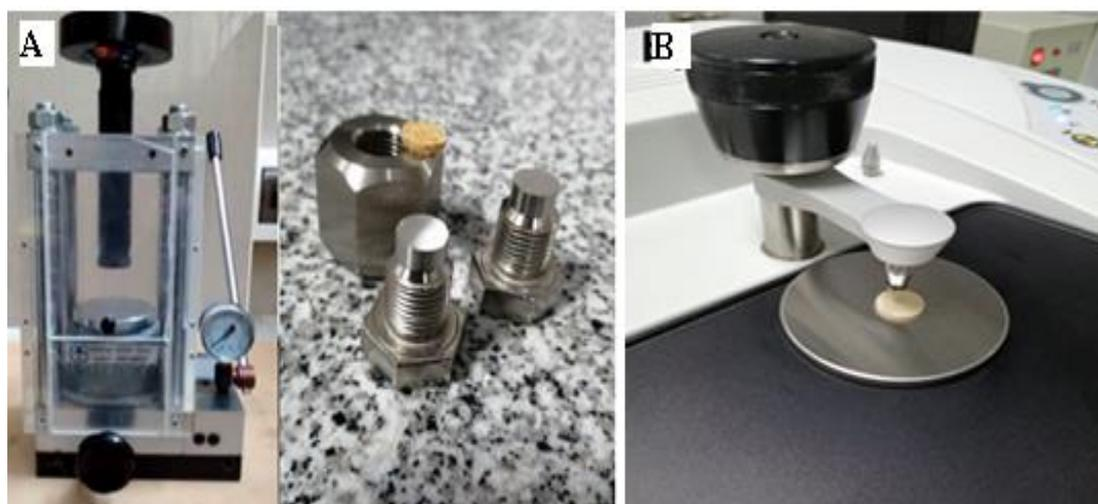
**Figura 17:** Equipos para el perfil  $\kappa$ -carragenina por medio del espectrofotómetro infrarrojo. (A) Econo-Press para formar pastillas, (B) Espectrofotómetro FTIR-ATR con una pastilla
