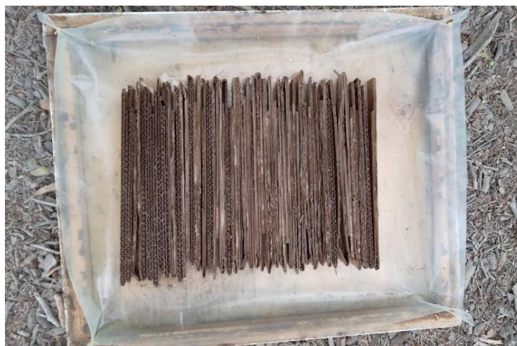
Figura 7: Tiras de cartón embebidas en la mezcla de ácido oxálico y glicerina
