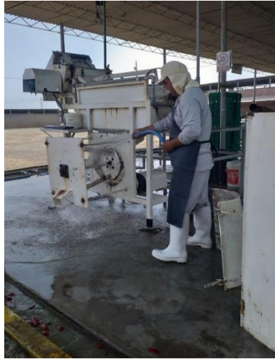
Figura 36: Máquina trilladora. Utilizada para trillar tomatillo, pimiento y tomates
