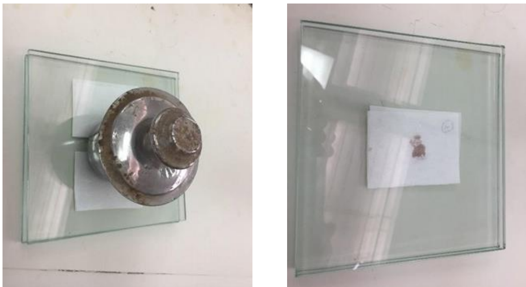
Figura 6: Procedimiento de prensado para obtención de la CRA
