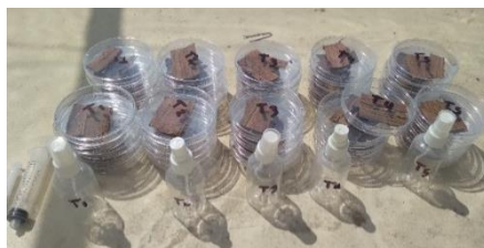
Figura 2. Materiales usados en el ensayo: 2 jeringas, 50 placas petri con porciones de corteza de vid y 5 sprays rotulados con los 5 tratamientos. Paracas, Ica – Perú.
