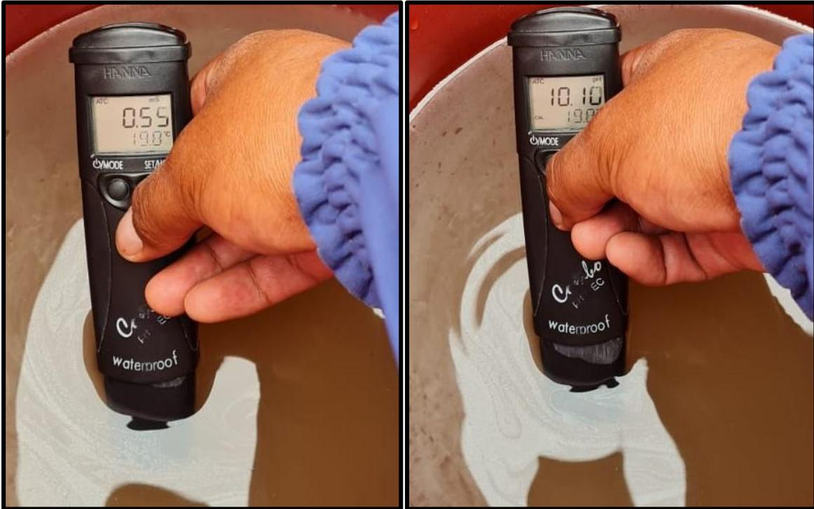
**Figura 21:** Conductividad eléctrica y pH del agua de riego CCPP Miraflores, Aucallama.
