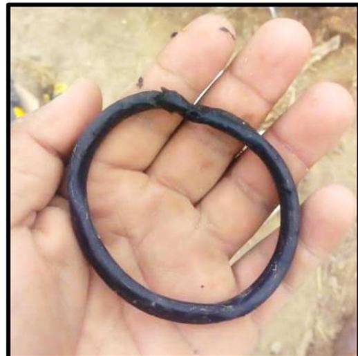
**Figura 19:** Instalación incorrecta del collarín. Corrupción del sello.
