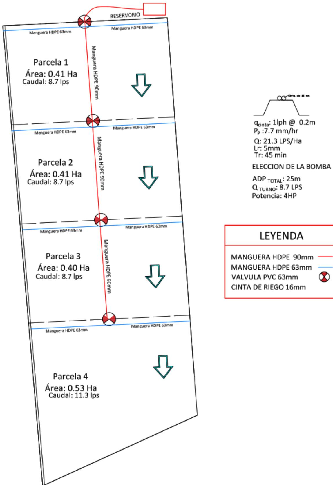
**Figura 22:** Plano de la instalación ejecutada por el agricultor para cultivo de fresa cv. Sabrina.
