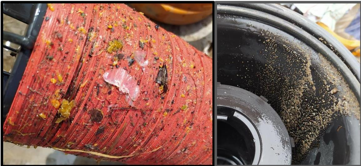
**Figura 20:** Obstrucción de filtro de anillos por mala calidad física del agua de riego.
